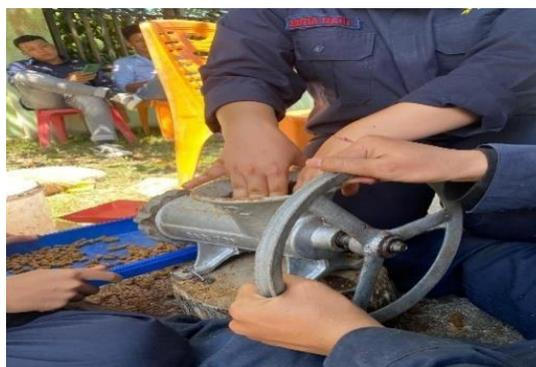
**Gambar 5.** Proses Pencetakan Adonan yang Sudah di Campurkan
